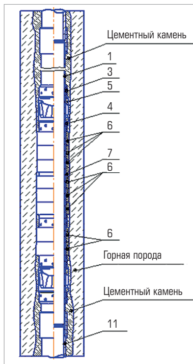
Рис. 10. Пакер в скважине
