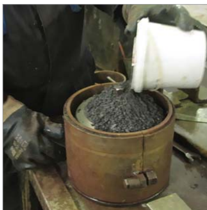
Рис. 5. Процесс насыпания резиновой крошки в пресс-форму
