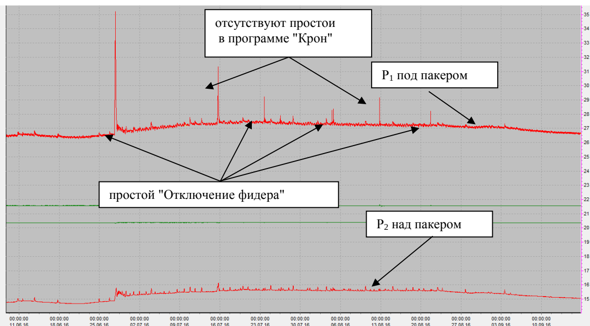
Рисунок 20. График изменения давления и температуры при простоях скважины с 11.06.2016 г. по 10.09.2016 г.
