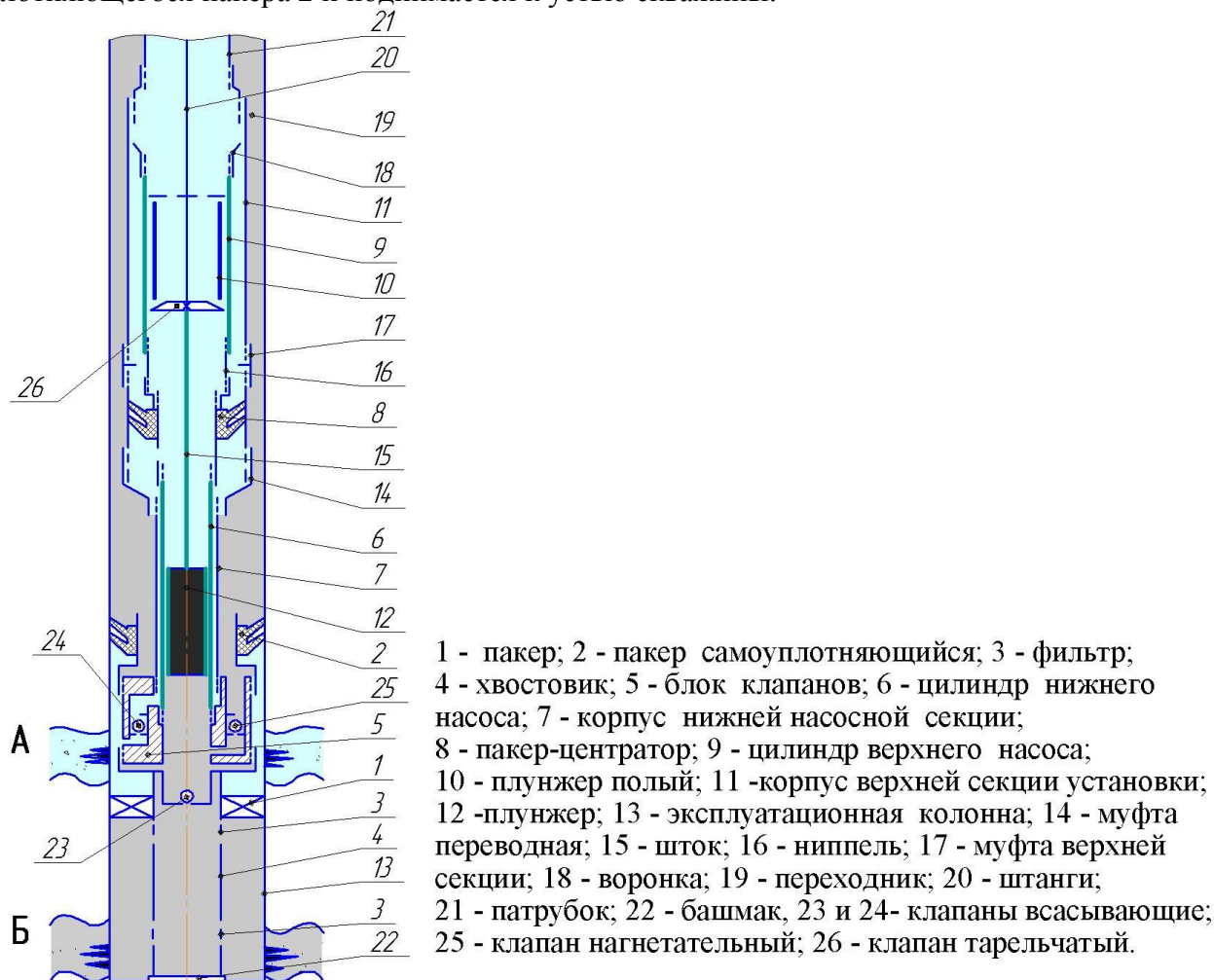
Рисунок 14. Подземное оборудование УОРЭ-1Р
