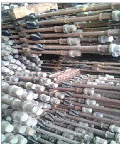
Рис. 18. Штанговые лопатки специального профиля на насосных штангах
