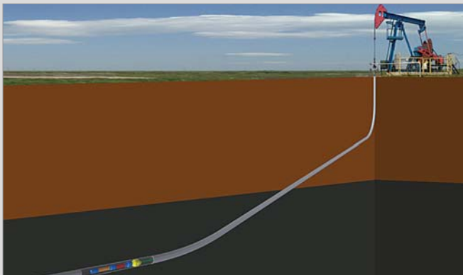
Рис. 15. Положение НД-НГВ в наклонно направленной скважине
