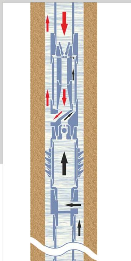
Рис. 4. Схема эжектора
