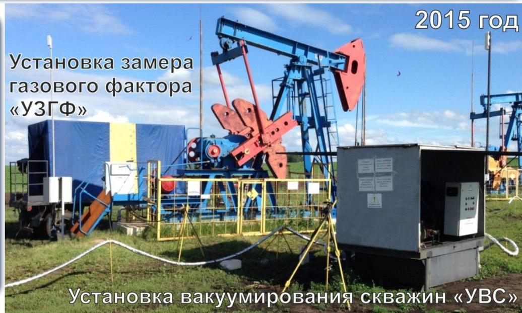
Вакуумирование затрубного пространства позволило снизить износ винтовых насосов, степень износа составила - 24%, снижение степени износа - 33%.
